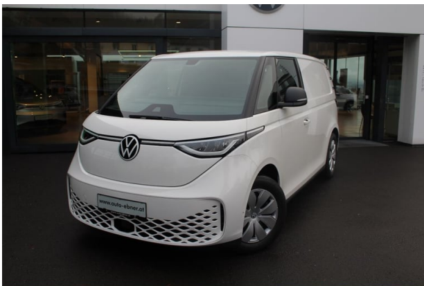
ID. Buzz Cargo 150 kW Batteriekapazität: 77 kW (netto) Ladeleistung: 11 kW AC & 170 kW DC Höchste Nutzleistung: 150 kW (204 PS)
